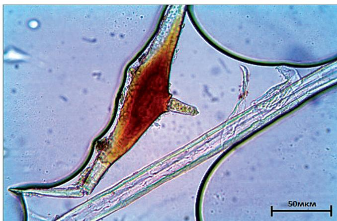
Рис. 2. Вид капсулированной смолы
