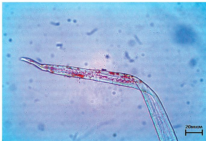
Рис. 3. Вид диспергированной смолы (размер до 5,0 мкм)
