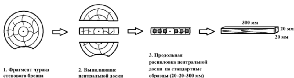
Рис. 2. Последовательность изготовления образцов
