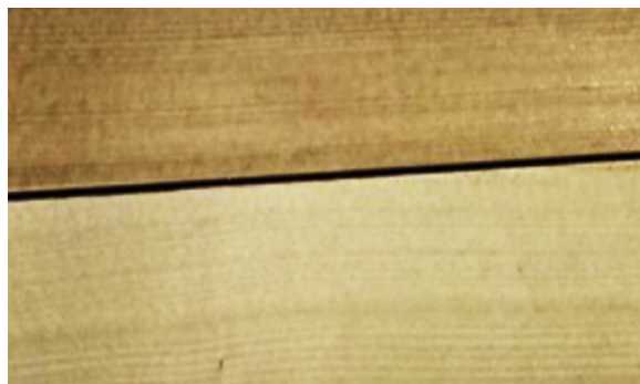
Рис. 4. Сопоставление дощечек выдержанной (сверху) и свежей (снизу) древесины ели
