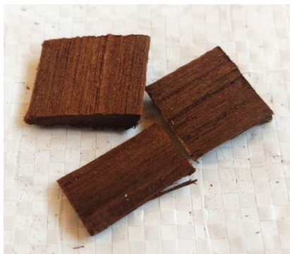
Рис. 1. Заполнитель из ТМД для получения ТДБ Fig. 1. The TMW filler for producing TWC
