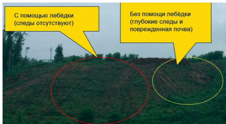
Рис. 3. Сравнительный вид последствий работ лесных машин на склоне с использованием и без использования лебедки [7]
