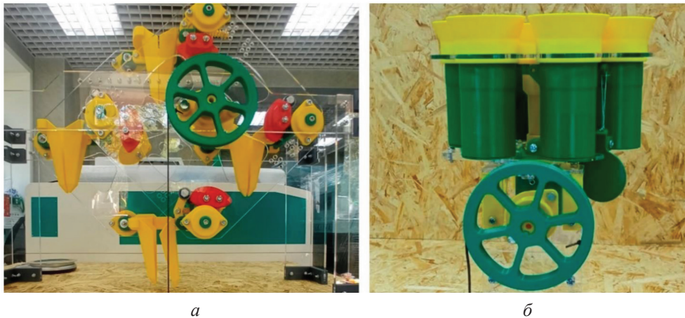
Рис. 6. Макет лесопосадочной машины: а – дисковый рабочий орган; б – подсистема подачи саженцев
