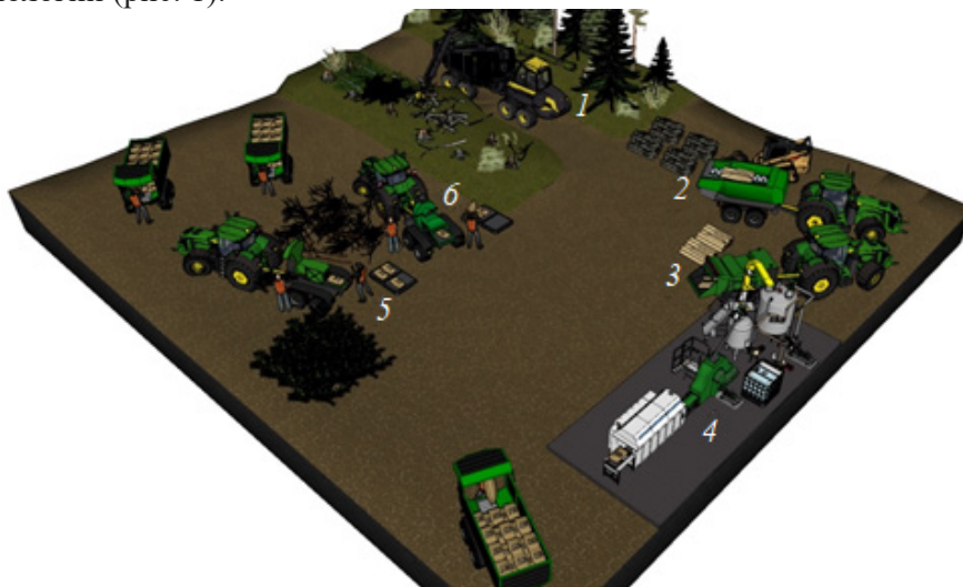
Рис. 1. Технологическая схема участков переработки древесного сырья: 1 – транспортно-сортировочная машина на базе форвардера; 2 – мобильная окорочная машина; 3 – мобильная рубительная машина; 4 – мобильная линия по производству древесноволокнистого полуфабриката; 5 – мобильная ножевая установка для производства хвойно-витаминной муки; 6 – мобильная ножевая установка для производства древесной муки
