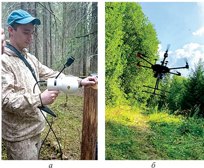
Рис. 1. Подеревная съемка насаждения при помощи технологии LIDAR:
