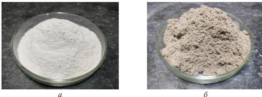
Рис. 1. Внешний вид: а – диацетат целлюлозы; б – древесный наполнитель
