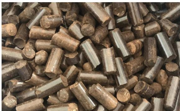
Рис. 2. Полученные гранулы из торфа и кордревесных отходов
