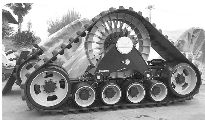
Рис. 2. Треугольный гусеничный модуль [12]
