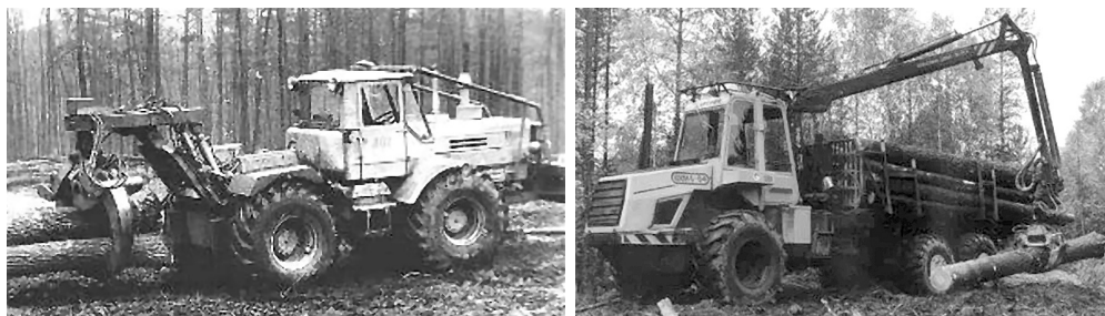
Рис. 1. Отечественные лесные колесные машины: слева – колесный трелевочный трактор ЛТ-157; справа – форвардер «Онежец» ШЛК 6-04
