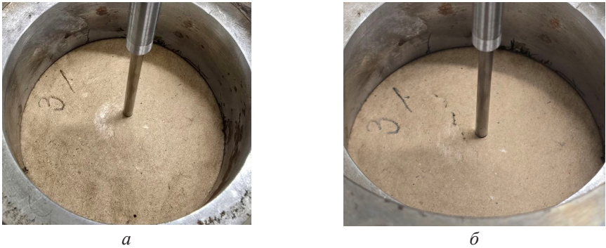
Рис. 4. Образцы мешочной бумаги с покрытием из агар-агара до нагружения (а) и в момент разрушения (б)
