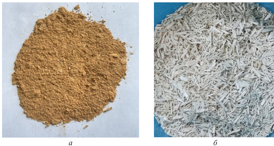
Рис. 1. Гнилая древесина: a – бурая трещиноватая гниль; б – белая волокнистая гниль
