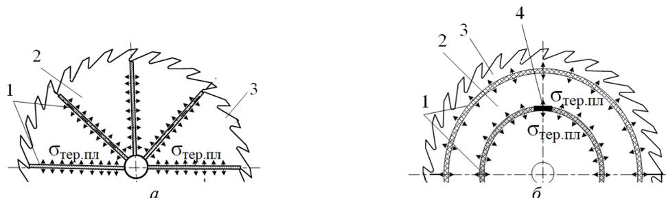
Рис. 1. Круглая пила: *a* – с радиальными зонами нагрева; *б* – с коаксиальными зонами нагрева: 1 – локальные разноректорно направленные узкополосные зоны нагрева; 2 – диск пилы; 3 – зубчатая кромка; 4 – элемент локальной узкополосной зоны ( $\sigma_{\text{тер.пл}}$  – термопластическое напряжение)
