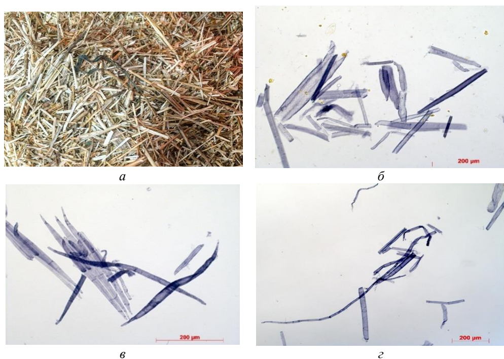
Рис. 1. Микрофотографии образцов из костры льна: a – исходное сырье; b–г – образцы целлюлозы 1–3 соответственно
