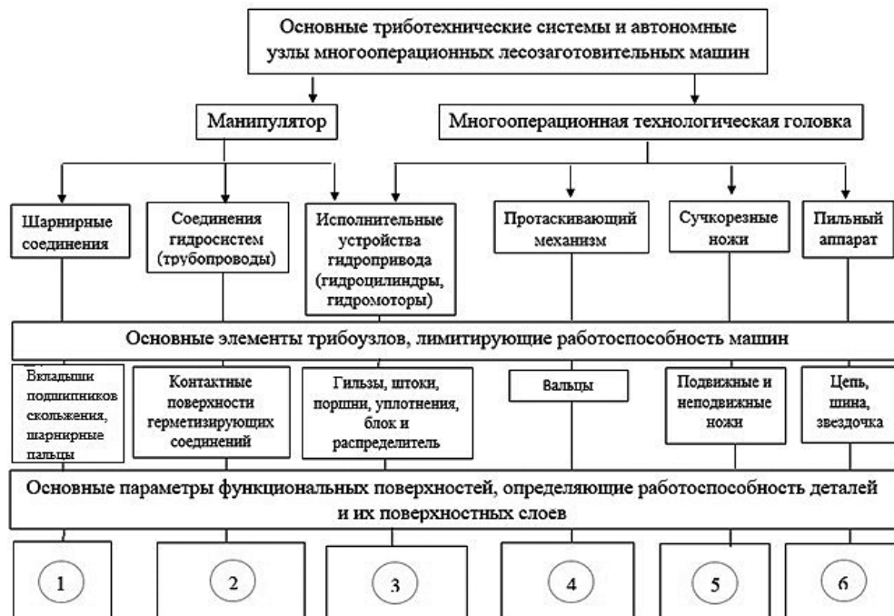
Основные триботехнические узлы и рабочие органы лесозаготовительных машин
