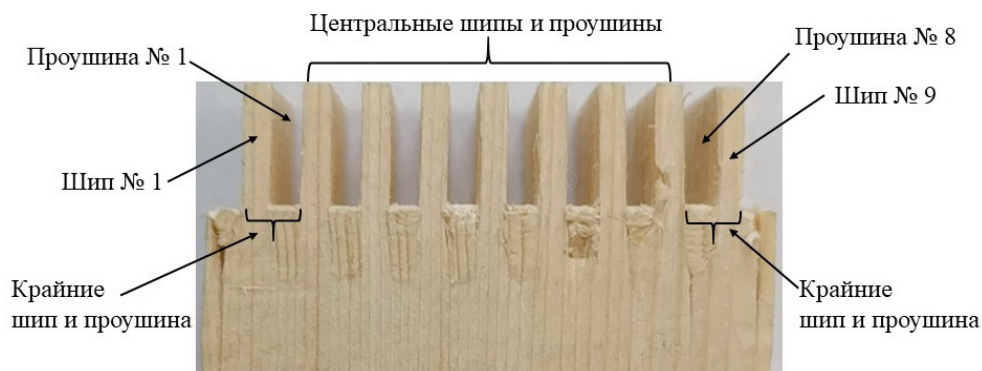
Рис. 3. Нумерация и обозначение шипов и проушин на детали
