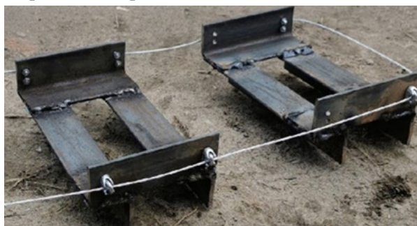
Рис. 1. Фрагмент ряда секций грунтозацепов из уголка 50×50×5 мм
