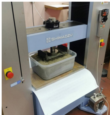
Рис. 2. Вдавливание секции грунтозацепов в грунт испытательной машиной
