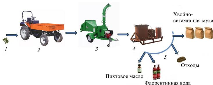
Рис. 6. Технологическая схема производства пихтового масла-сырца и переработки зелени в хвойно-витаминную муку
