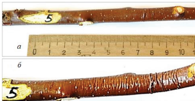
Рис. 3. Трансформация первоначально гладкой поверхности коры (а) в волнообразную поверхность (б) в зоне сжатия при изгибе [7]
