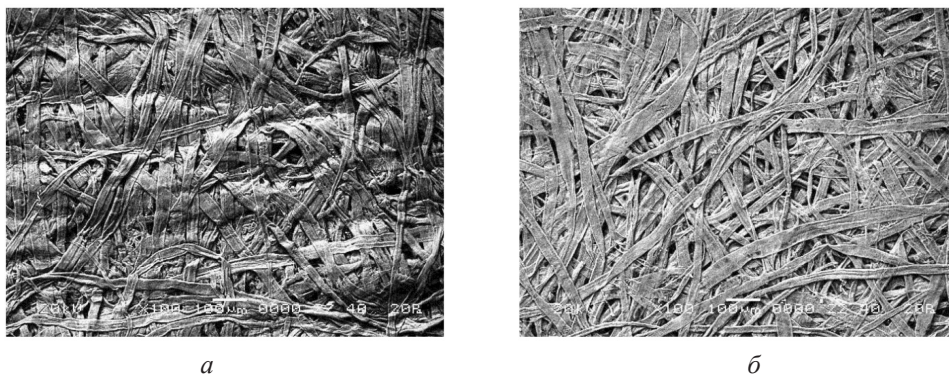
Рис. 7. Сканограммы поверхности бумаги (сканирующая электронная микроскопия, увеличено в 100 раз): а – микрокрепированная влагопрочная макулатура; б – бумага на основе вторичного волокна
