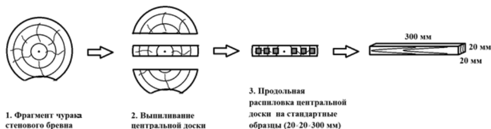
Рис. 2. Последовательность изготовления образцов
