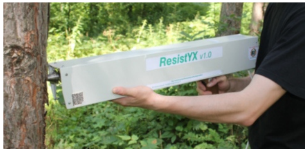
Рис. 3. Устройство для измерения сопротивления сверлению ResistYX
