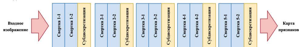
Рис. 6. Архитектура нейронной сети VGG16
