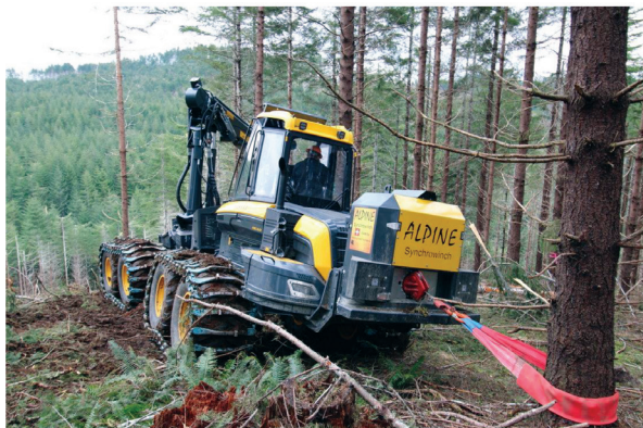
Рис. 1. Харвестер компании Ponsse, оснащенный лебедкой Synchronwinch [10]
