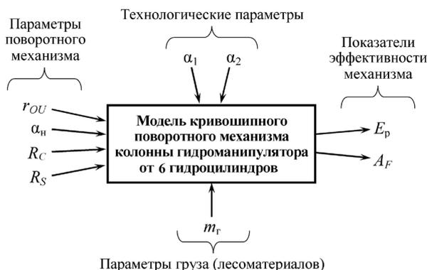
Рис. 3. Входные и выходные параметры разработанной математической модели [5]
