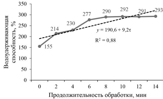
Из рис. 2 видно, что увеличение водоудерживающей способности массы до 290 % наблюдается при продолжительности обработки от 2 до 6–8 мин. После этого показатель стабилизируется и практически не возрастает, поэтому дальнейшую обработку проводить нецелесообразно. Стоит отметить, что при использовании в качестве сырья древесной коры водоудерживающая способность получаемой массы более высокая и достигается за более короткое время в сравнении с древесиной [7].
